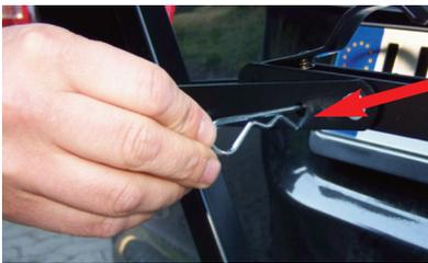
**3. Sicherungssplint durch beide Spannschenkel durchschieben.**
