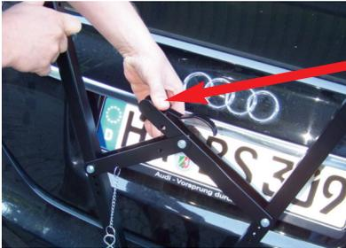
**2. Spannschenkel am hinteren Ende nach unten drücken bis der Sicherungshebel einrastet.**
