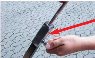
**4. Edelstahlbügel mit der Flügelschraube auf dem Unterteil festschrauben.**
