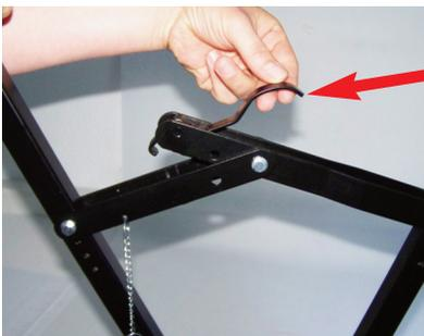
**5. Zum Lösen der Aufbrechhilfe vom Kugelkopf den Sicherungshebel nach oben ziehen.
