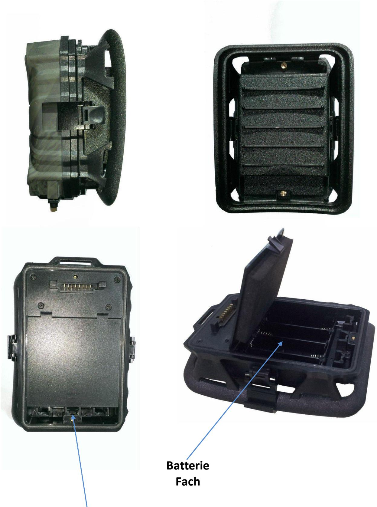
Hier drücken zum Batteriefach zu öffnen
