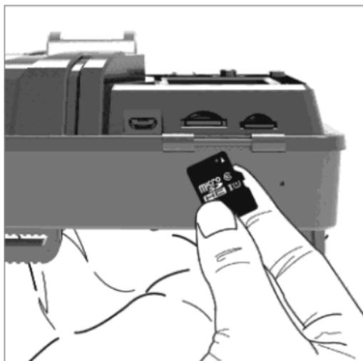
2. Um die Micro SD-Karte zu entfernen, drücken Sie die SD-Karte nach innen, um sie zu lösen.
